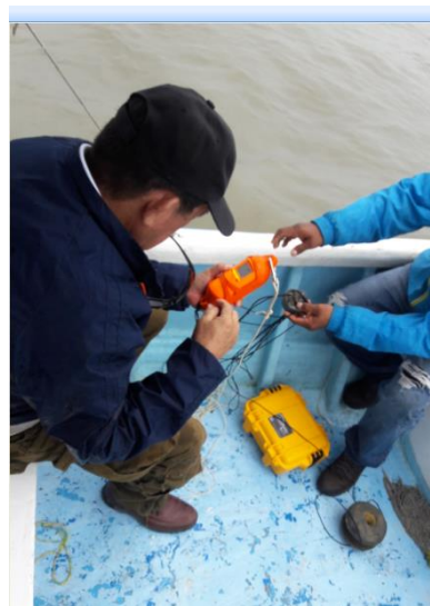
Fotografía 2.- Toma de velocidad del sonido.
