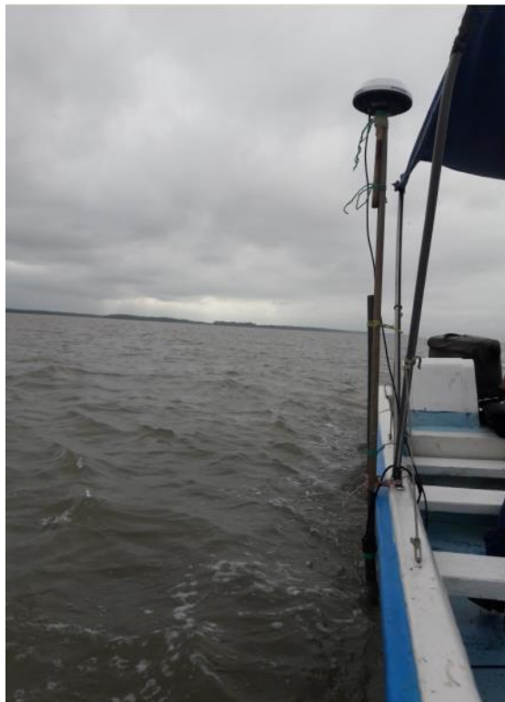
Fotografía 3.- Instalación del transductor y la antena del DGPS
